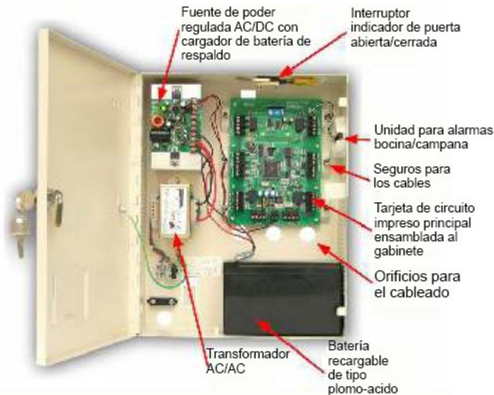
Figure 2. Diseño del Hardware AC-215
