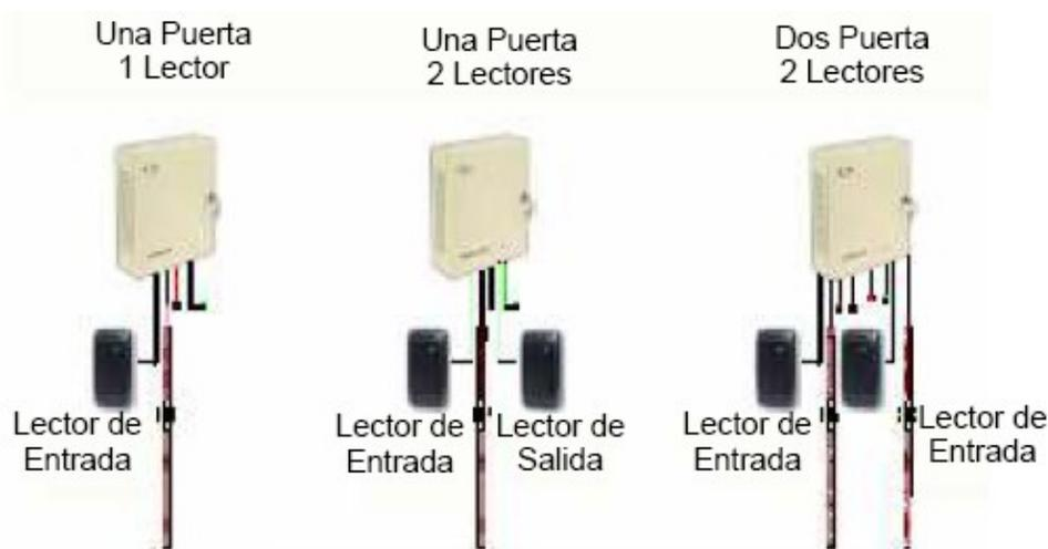
Figure 3. Configuraciones del AC-215
